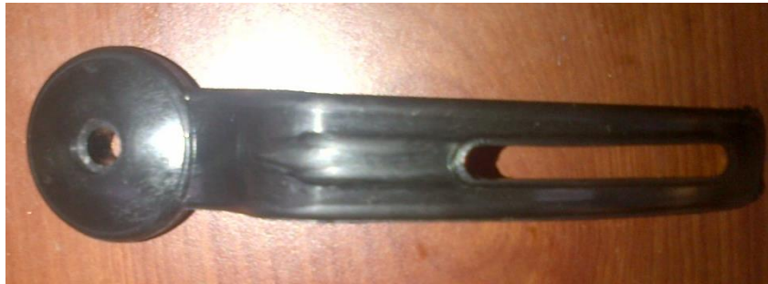
Anexo 21 “Diadema inyectada en buen estado”
