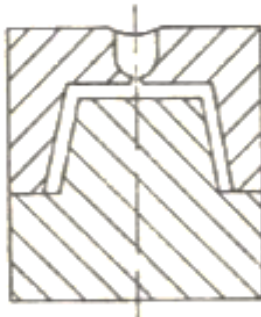
Figura 23 Vaso inyectado por el fondo, posición de entrada favorable para la salida de aire
