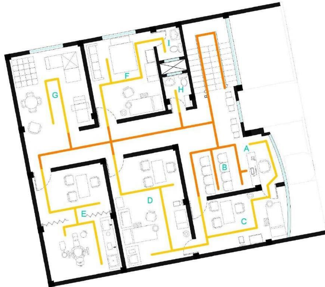
Ilustración 48: Diagrama de distribución espacial y circulación de la Clínica Firenze. Condicionante planta alta.
