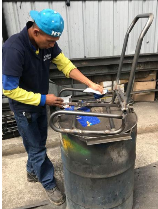
Figura 3. 15. Limpieza de superficies. Fuente: Autor
