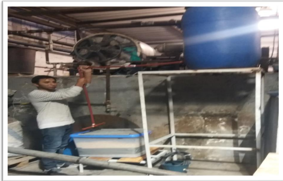
Ilustración 12. Colocación del filtro en la lavadora de jeans “Multiprocesos Gallegos”
