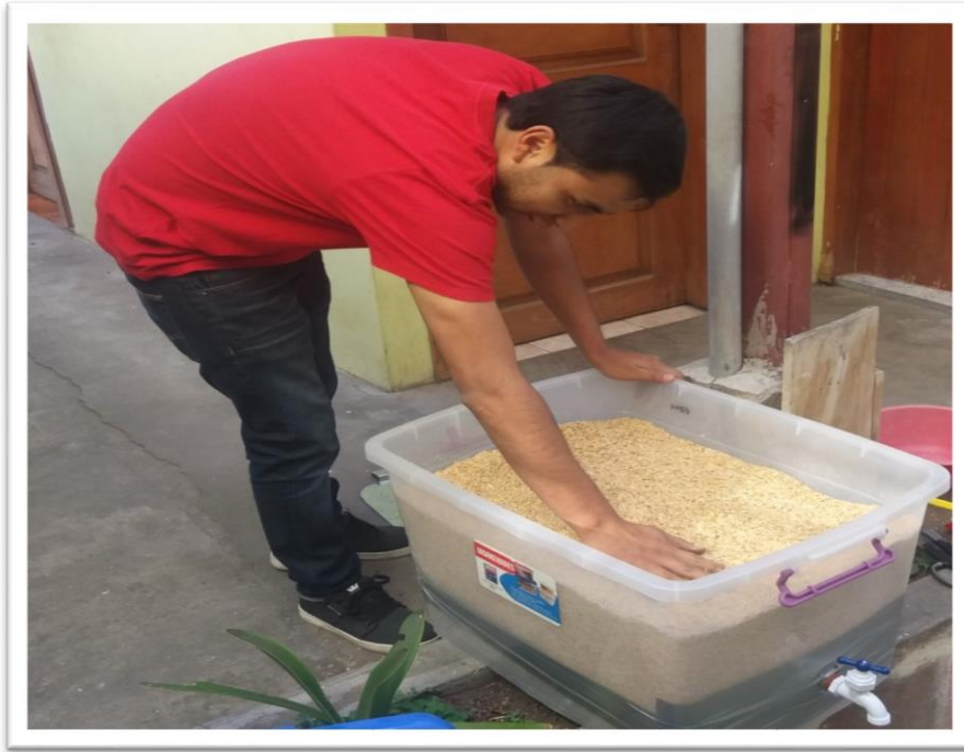
Ilustración 10. Colocación de la cascarilla de arroz en el recipiente plástico
