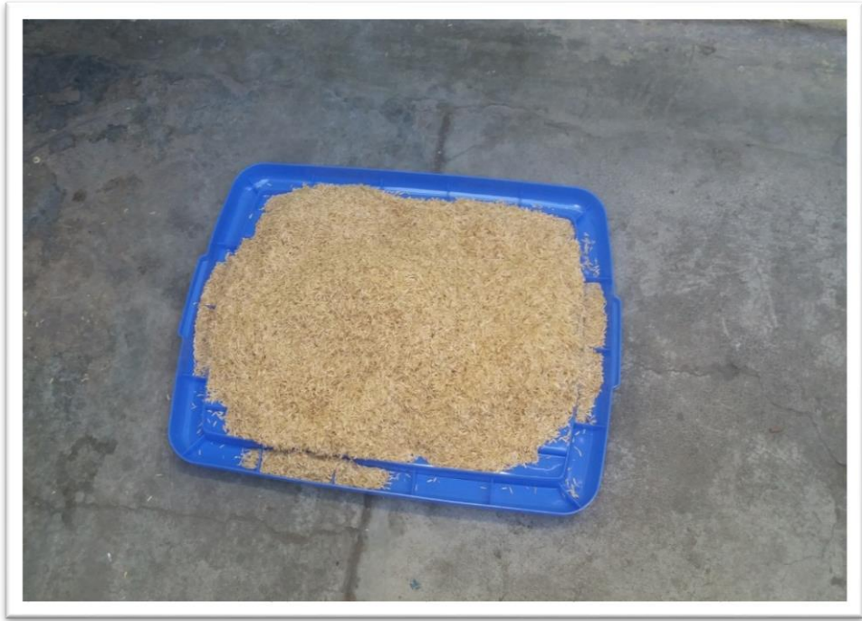
Ilustración 5. Material filtrante cascarilla de arroz
