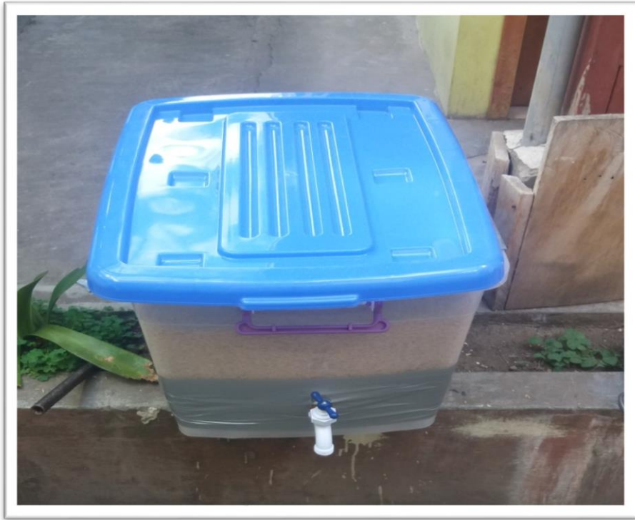
Ilustración 11. Filtro de cascarilla de arroz
