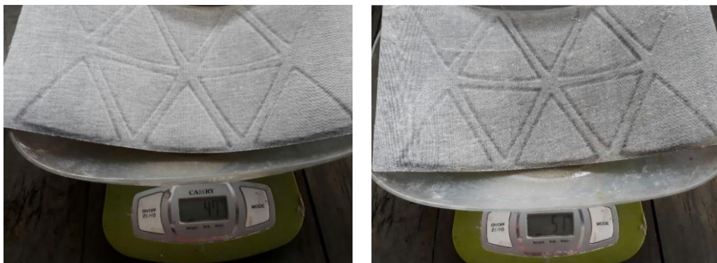
Figura 3.7. Revision de pesos antes y despues de la aplicación del latex, [Autor].
