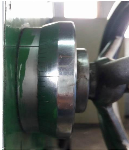
Fig. 2.9: Profundidad de corte (milésimas de pulgada o mm), [Autor]
