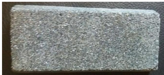
Fig. 2.18: Muela abrasiva de Carburo de Silicio, [Autor]
