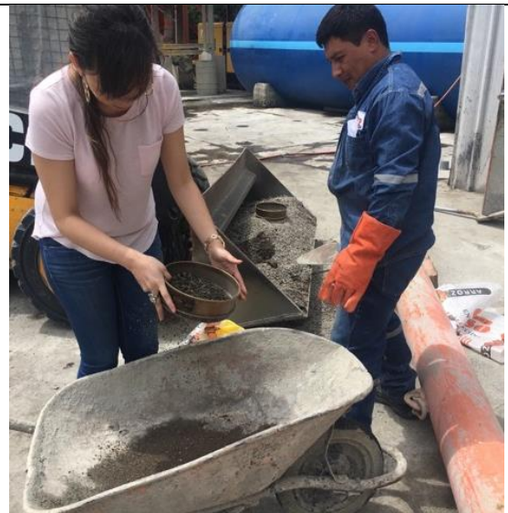
Imagen 14. Realizando el Tamizaje con el tamiz #4
