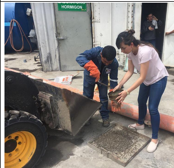
Imagen 13. Realizando el Tamizaje con el tamiz 3/8
