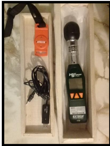
Figura 21: Medidor de estrés térmico WBGT modelo HT30.
