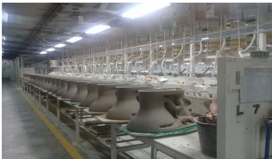
Figura N° 19 Sección de colado
