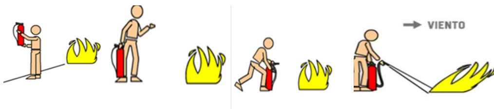
Figura N° 37 Uso de extintor
