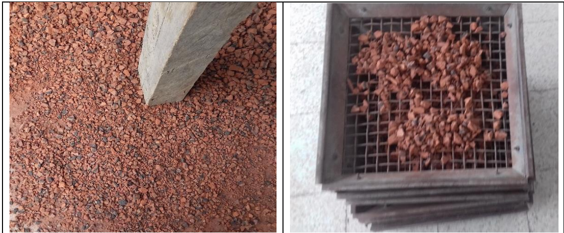
Imagen 6. Obtención del material filtrante
