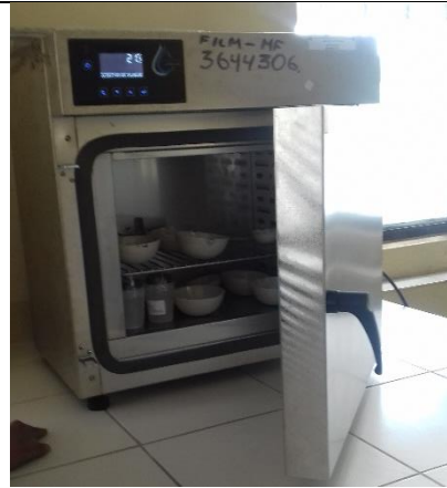
Secado del material en horno a 40°C
