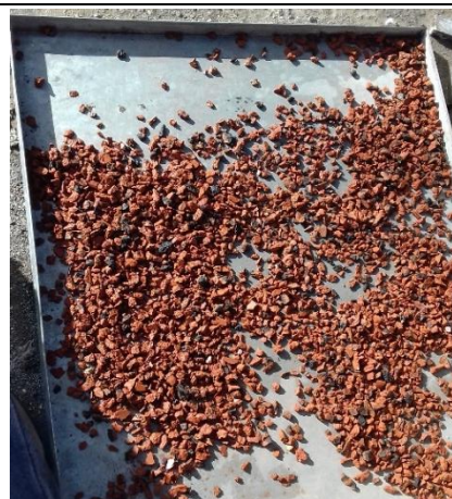
Ladrillo triturado saturado, determinación del peso más canastilla.
