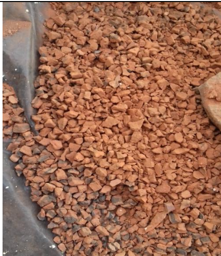
Obtención del ladrillo triturado
