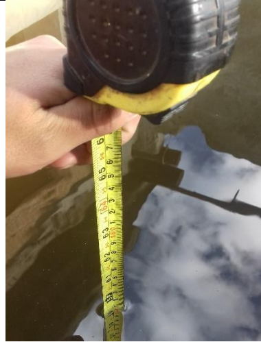
Lectura de nivel de agua para determinar el volumen de agua consumida
