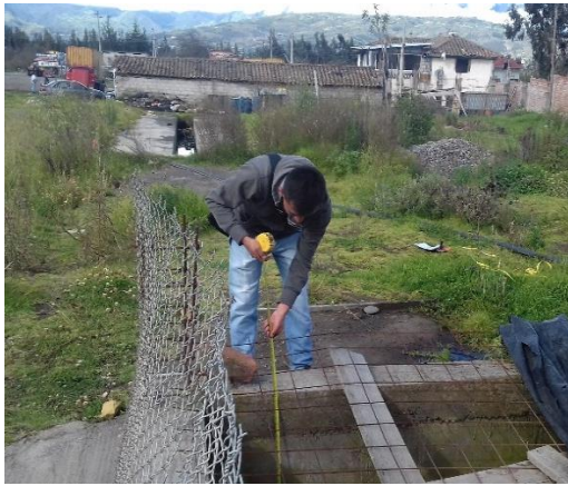
Toma de datos para determinar el caudal de entrada
