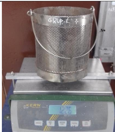
Peso canastilla vacía, proceso para determinar el peso específico del material
