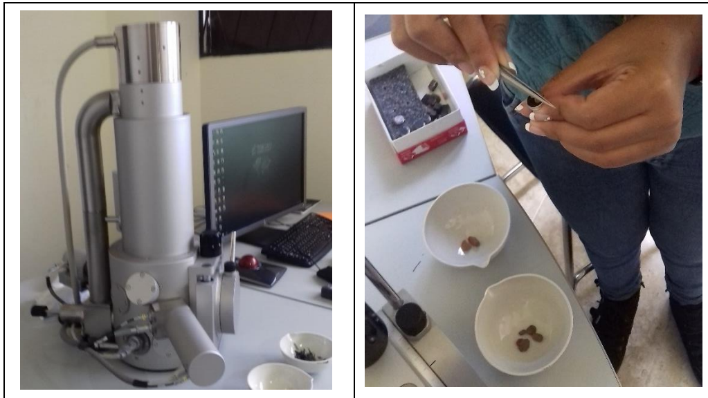
Imagen 7. Caracterización del ladrillo triturado en la maquina microscopio electrónico de barrido (SEM)
