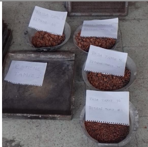
Tamizado del material
