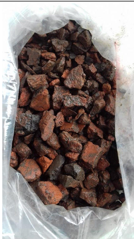
Muestra de ladrillo triturado después de la filtración, afectada por contaminantes
