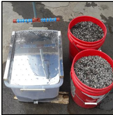
Fotografía 7. Colocación de la grava y de la lata de distribución
