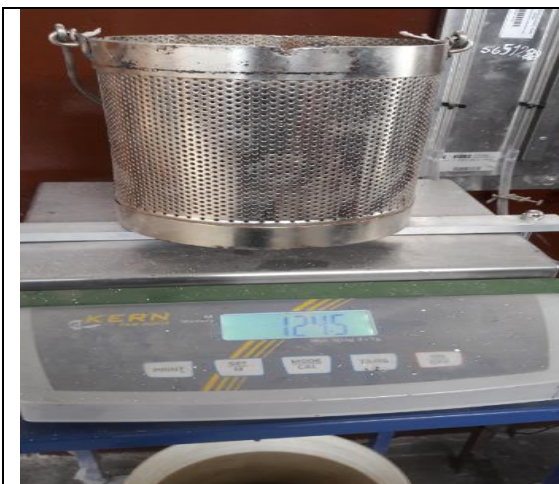
Ensayo de densidad de la grava
