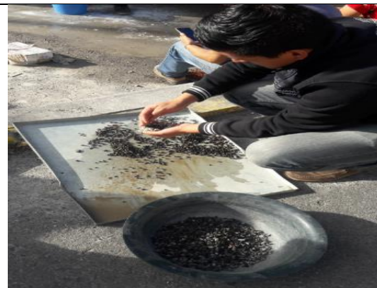
Lavado y secado de la grava para ensayo de densidad
