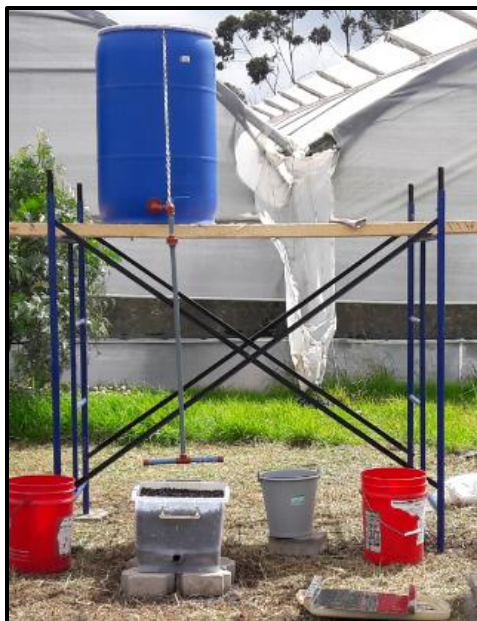
Fotografía 9. Colocación del filtro de grava
