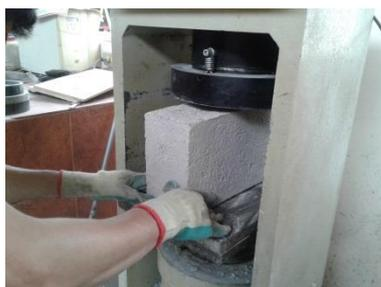
*Fotografía N° 17. Colocación del bloque celular en la máquina de compresión*
