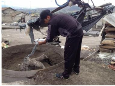
*Fotografía N° 7. Adición de polvo de aluminio a la elaboración del bloque celular*
