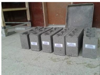
*Fotografía N° 15. Peso del bloque celular saturado*
