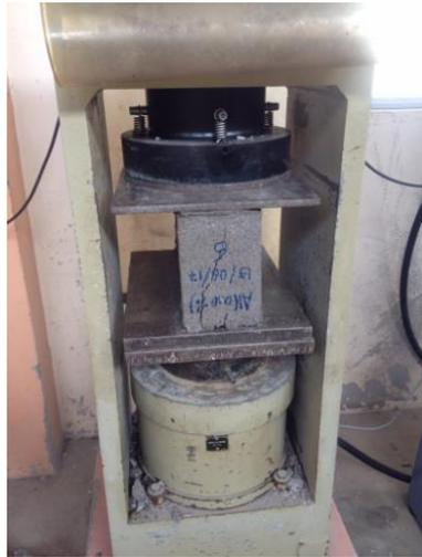
*Fotografía N° 19. Ruptura del bloque celular*
