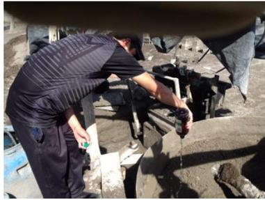
*Fotografía N° 9. Adición de peróxido de hidrógeno a la elaboración del bloque celular*
