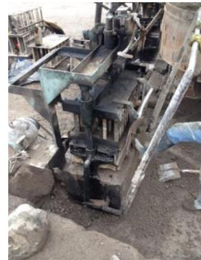
*Fotografía N° 6. Máquina para la elaboración de bloques*
