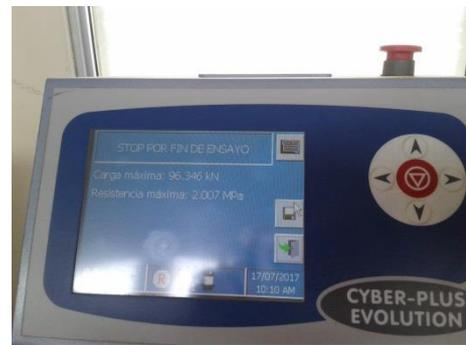
*Fotografía N° 20. Resultados arrojados por la máquina de compresión*
