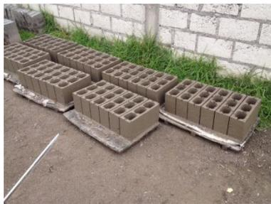
*Fotografía N° 11. Bloques celulares con la adición de polvo de aluminio y peróxido de hidrógeno*
