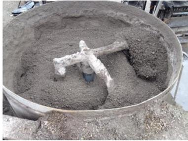
*Fotografía N° 1. Mezcla de los materiales del bloque celular*
