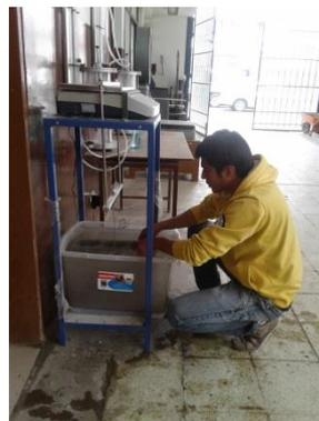
*Fotografía N° 14. Peso del bloque celular sumergido*
