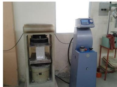
*Fotografía N° 22. Máquina de compresión*
