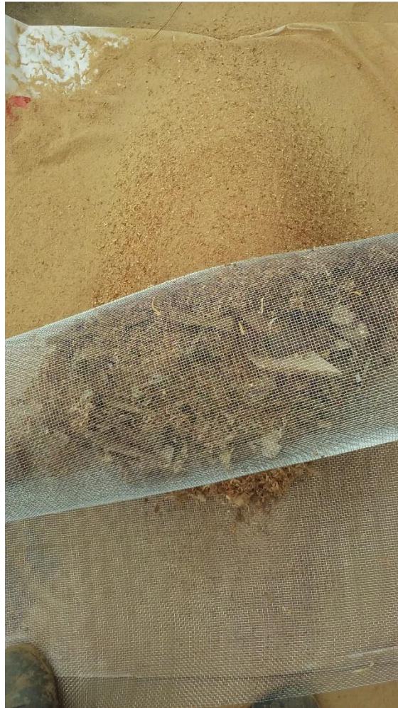
Separación de la viruta del aserrín.
