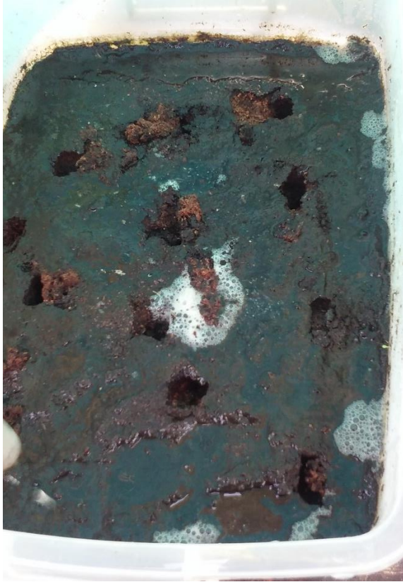
Limpieza de la capa superior del biofiltro despues de 60 dias de funcionamiento
