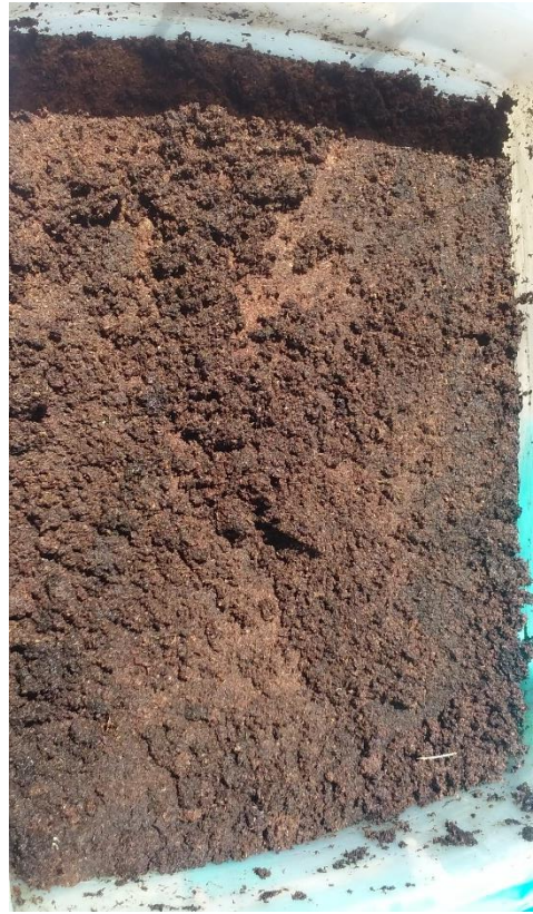
Limpieza de la capa superior del biofiltro despues de 60 dias de funcionamiento
