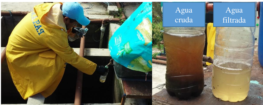
Toma de muestra para realizar el análisis visual diario durante el periodo de funcionamiento del biofiltro
