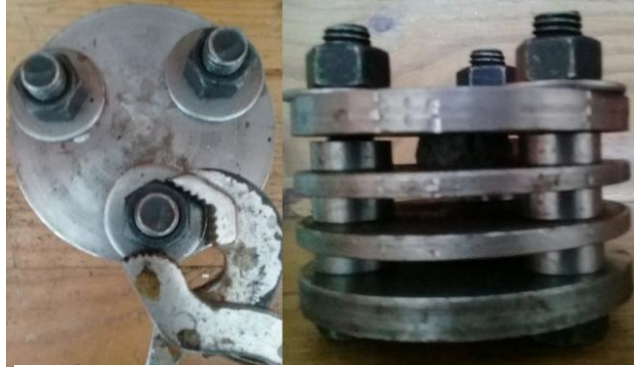
Fig. 50. Ajuste de los tornillos del aparato de compresión Fuente: Colorplast
