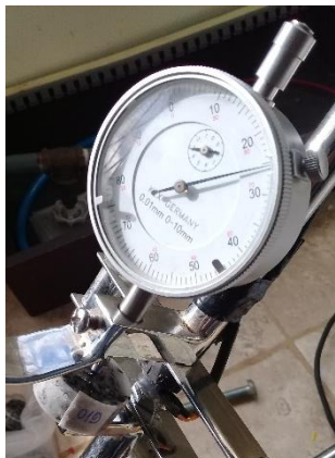
Fig. 49. Reloj comparador micrométrico Fuente: Colorplast
