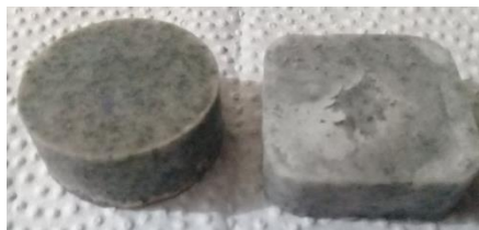
Fig. 43. Probetas para ensayos de compresión y dureza Fuente: El autor
