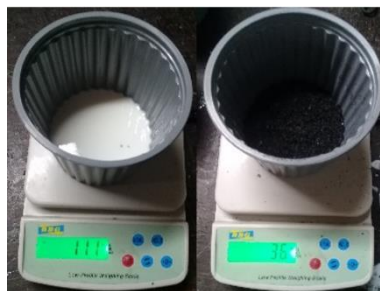
Fig. 38. Pesaje de látex y gránulo de caucho Fuente: Colorplast
