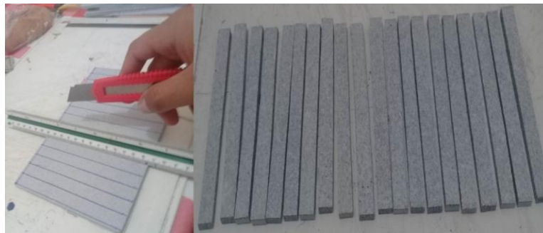
Fig. 45. Corte de probetas para ensayos de inflamabilidad Fuente: El autor
