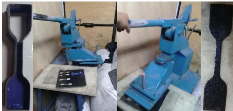
Fig. 44. Corte de probetas para ensayos de tracción con troquel Fuente: Colorplast
