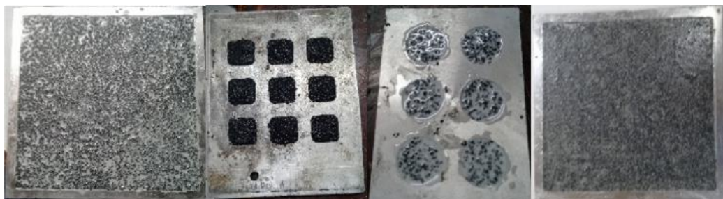
Fig. 40. Aplicación del material compuesto en los moldes Fuente: El autor
