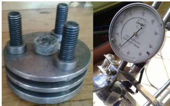
Fig. 51. Medición de las probetas de compresión luego del ensayo Fuente: Colorplast
