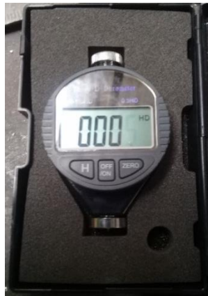
Fig. 52. Medidor de dureza (Durómetro) Fuente: Colorplast
