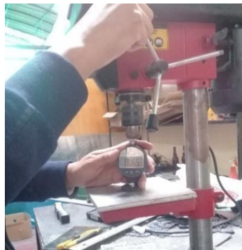
Fig. 53. Dispositivo mecánico que controla profundidad y fuerza Fuente: Colorplast
