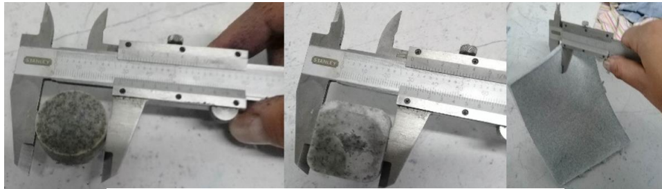
Fig. 42. Control de calidad de probetas y láminas Fuente: El autor
