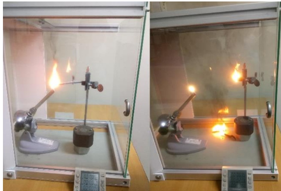
Fig. 57. Medición de velocidad de quemado Fuente: LEMAT
