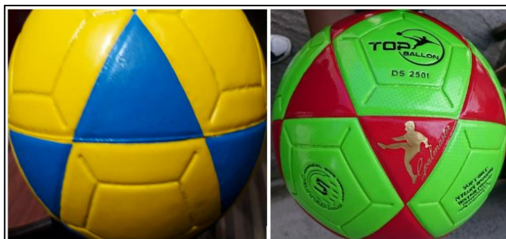
Figura 3.5 Aparición de línea por apriete inadecuado vs moldeado correcto (Fuente: Elaborado por el autor)
