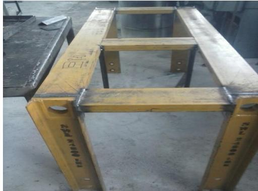
d. Armado de soporte para el reductor
