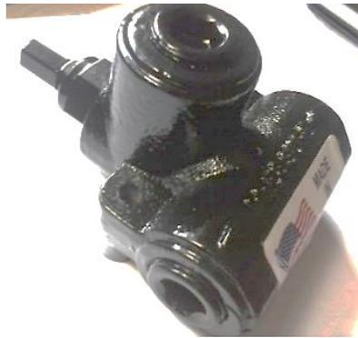
Figura 3.18 Válvula limitadora de presión PRINCE
