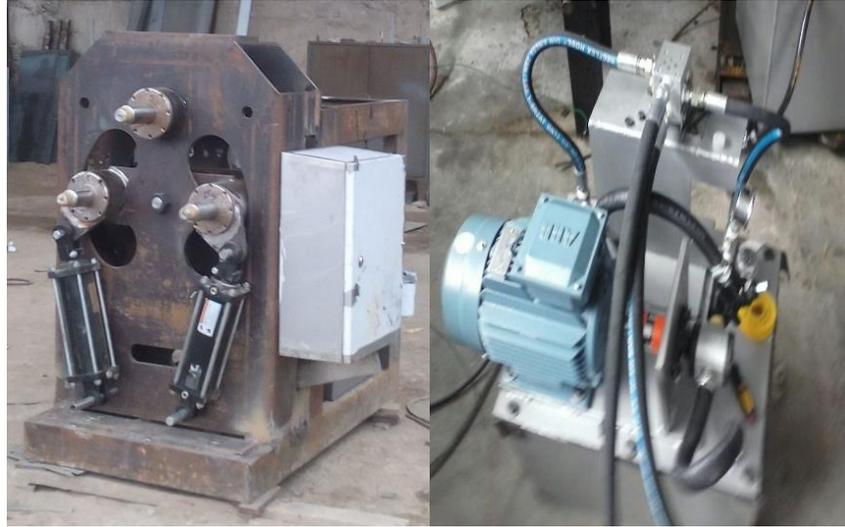
Figura 3.65 Elementos principales de la máquina dobladora
