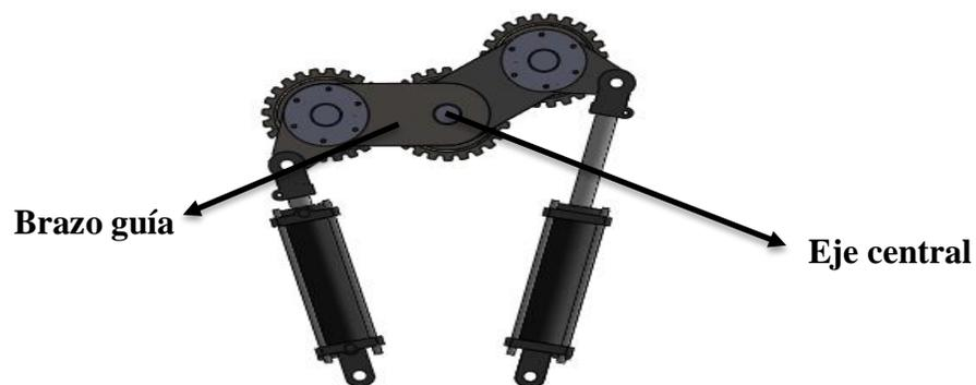
Figura 3.44 Mecanismo de eje central y brazo guía
