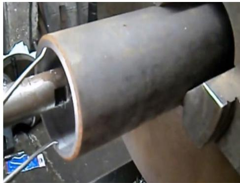
j. Mecanizado de base estructura unión reductor
