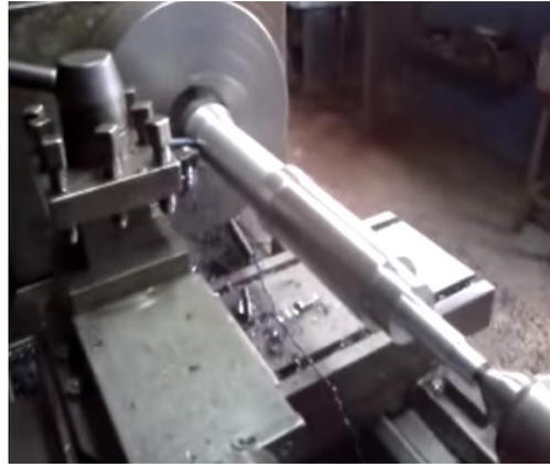
h. Mecanizado de tapas de rodamientos de eje
