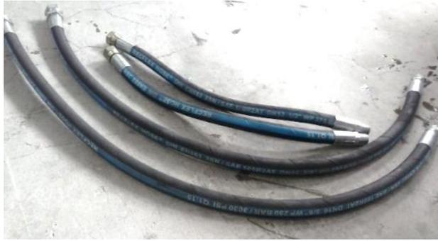
Figura 3.15 Mangueras hidráulicas armadas REC-FLEXHOSE
