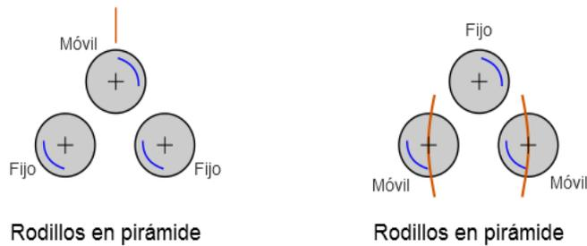
Figura 2.5 Disposición de los rodillos en forma de pirámide [9, p. 17]
