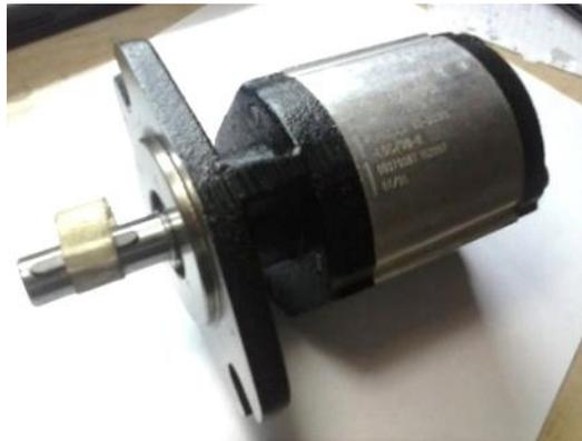
Figura 3.10 Bomba hidráulica CASAPPA
