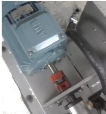
Figura 3.20 Acoplamiento entre motor-bomba
