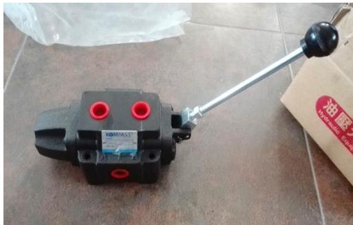
Figura 3.17 Válvula FluiDyne 4/3 vías
