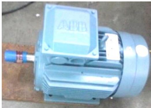
Figura 3.11 Motor eléctrico ABB
