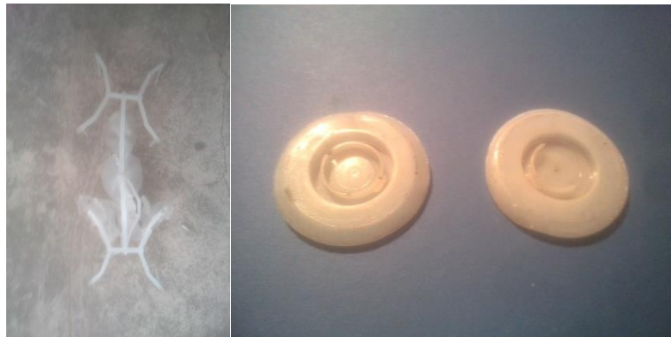
Figura 3. 35 Mazarota y tapa de la segunda inyección
