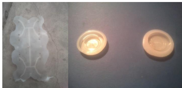
Figura 3. 34 Mazarota y tapa de la primera inyección
