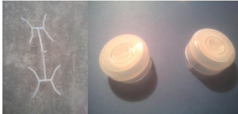
Figura 3. 36 Mazarota y tapa de la tercera inyección
