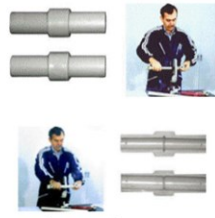
Gráfico 7: Proceso de Termofusión - Corte
