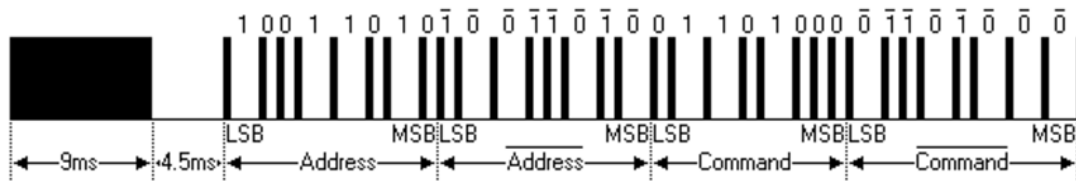
Figura 4.37: Trama Protocolo NEC-32 [97]
