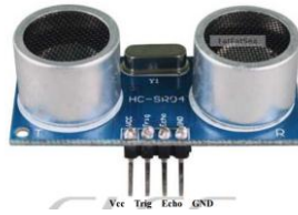
Figura 4.10: sensor ultrasónico HC-SR04 [64]
