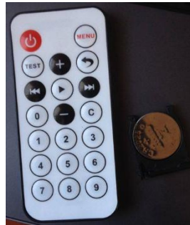
Figura 4.32: Transmisor IR (Control Remoto)
