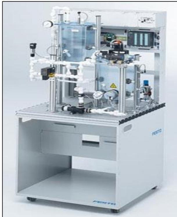
Fig. 13. Célula analógica FESTO MPS PA® Compact Workstation
