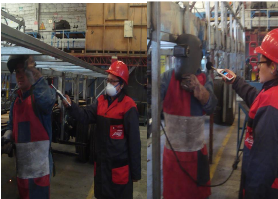
Fotografía 8. Medición de ruido al puesto de soldador de estructura
