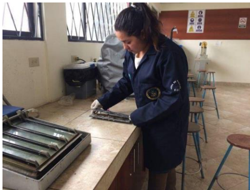
Figura 32. Colocación de la tapa del molde.
