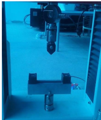
Figura 18. Equipo para ensayos a flexión en máquina universal MTE-50.
