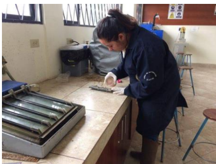
Figura 41. Verter la resina en la fibra colocada en el molde.
