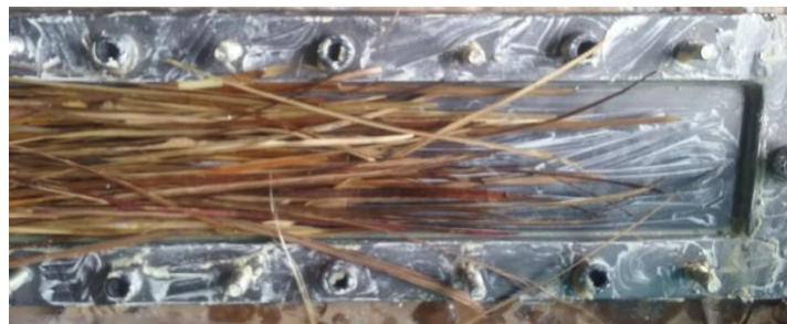
Figura 48. Colocación de la fibra pesada en el molde.
