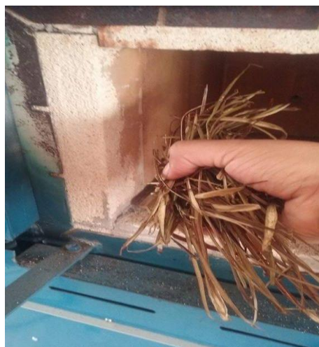
Figura 22. Colocación de la fibra en el horno.
