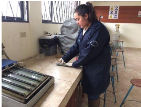
Figura 39. Colocación de la fibra en el molde.
