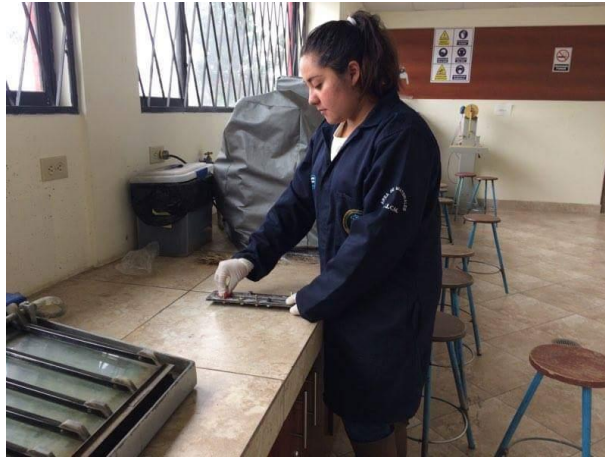
Figura 26. Limpieza del molde.
