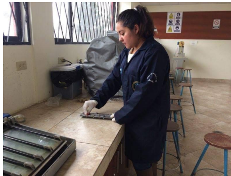
Figura 37. Limpieza del molde.
