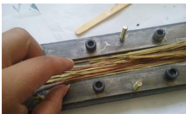
Figura 29. Fibra colocada en el molde.
