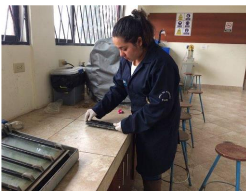
Figura 42. Colocación de la tapa en el molde.
