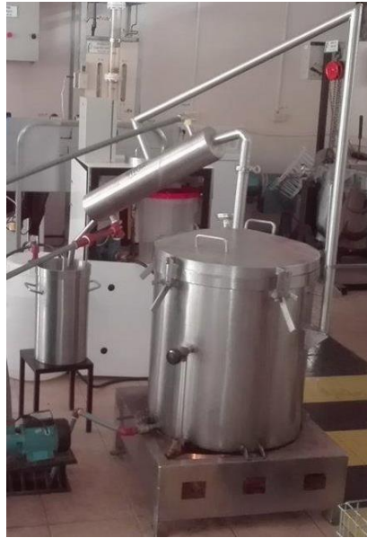
Anexo 1. Obtención de los extractos por el método de destilación por arrastre de vapor en equipo Clevenger
