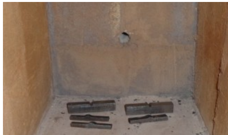
Figura 6.28 Probetas recocidas a 600°C por una hora Fuente: Autor
