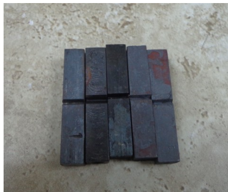
Figura 6.45 Probetas preparadas para realizar el ensayo de Impacto según ASTM 23:02 (ANEXO B6)
