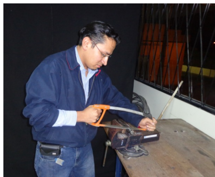
Figura 6.6 Corte de las probetas de acero AISI 1018 Fuente: Autor
