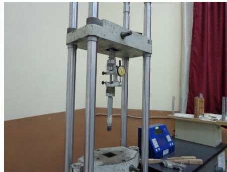
Figura 6.19 Máquina Universal TiniusOlsen capacidad 30 ton.
