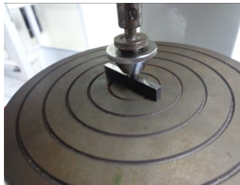
Figura 6.43 Mediciones desde el centro de la Soldadura Fuente: Autor
