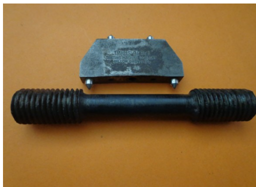
Figura 6.20 Marcas calibradas para colocar el deformímetro.
