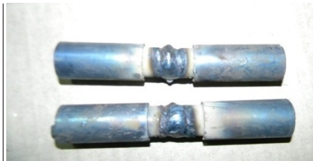
Figura 6.11 Probetas soldadas para maquinado
