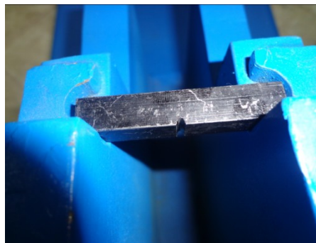
Figura 6.47 Probeta anclada al péndulo Charpy Fuente: Autor
