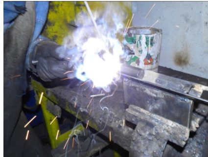
Figura 6.8 Soldadura de las probetas Fuente: Autor
