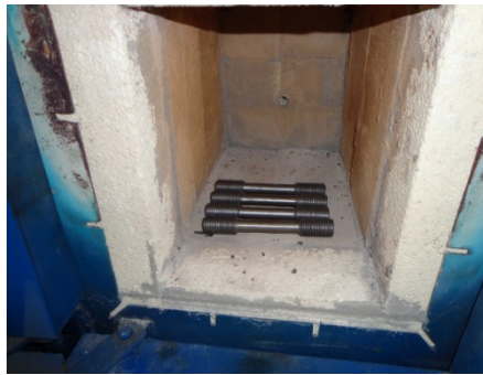
Figura 6.17 Horno con las probetas para el recocido Fuente: Autor
