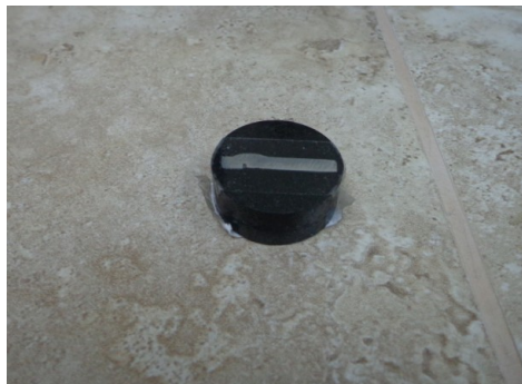
Figura 6.30 Montaje de la probeta en baquelita. Fuente: Autor
