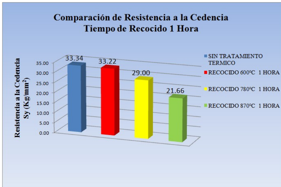
Figura 4.3 Comparación de Resistencia a la Cedencia (Sy) Tiempo de recocido: 1 hora Fuente: Autor
