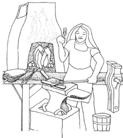
Figura2.7 La operación de soldadura debe haberse visto en forma similar a esta ilustración durante el siglo XVII.
