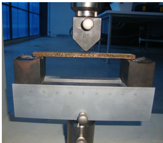
Figura 17. Ensayo de flexión
