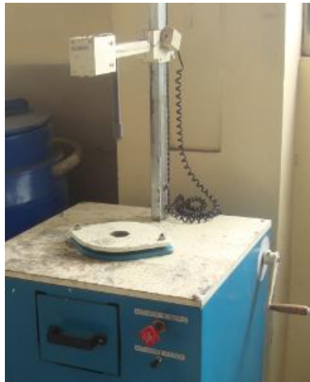
Figura 19. Geometría del ensayo caída del dardo
