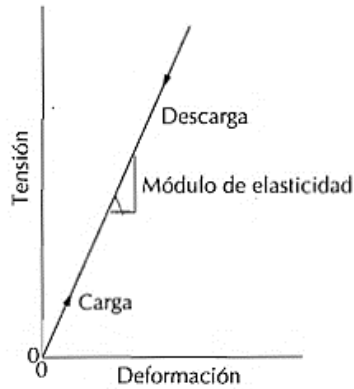
Figura 16. Diagrama tensión-deformación (deformación lineal para ciclos carga-descarga)
