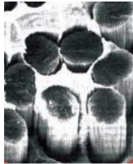
Figura 7. Microfotografía obtenida por microscopía electrónica de barrido de la superficie de fractura de una aleación plata-cobre, reforzada con fibras de carbono.
