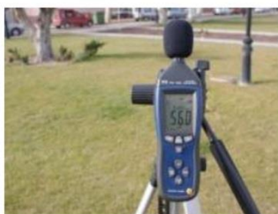
Sonómetro PCE-322A midiendo el nivel de ruido
