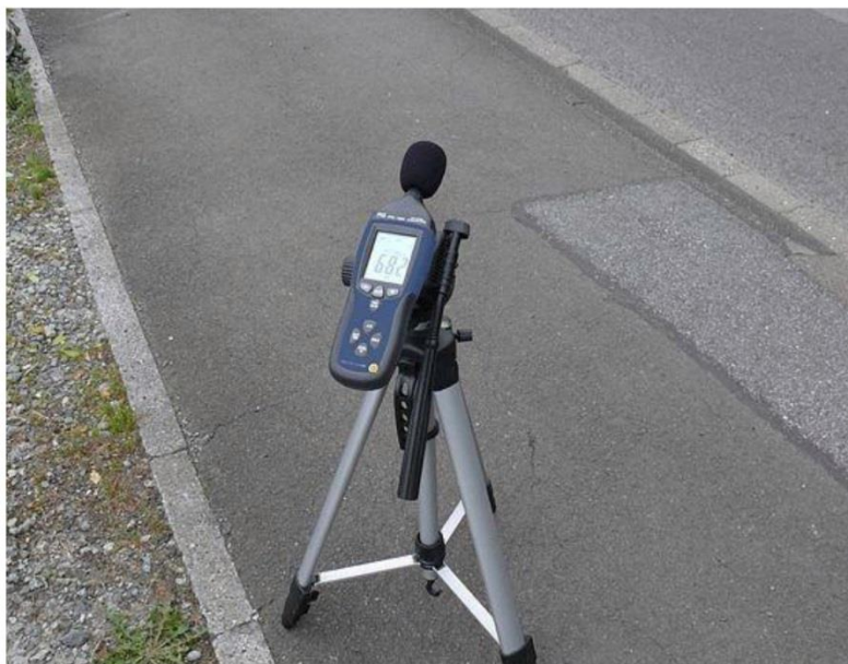
Sonómetro PCE-322A utilizado para medir el ruido del tráfico montado sobre un trípode
