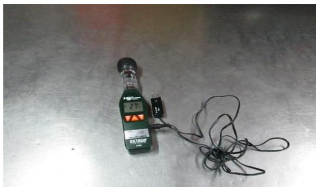
Gráfico N° 26. Termómetro medidor de Estrés Térmico WBGT 800036
