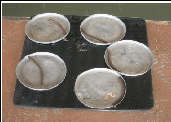
Muestra de Suelo para Contenido de Humedad de Límite Líquido.
