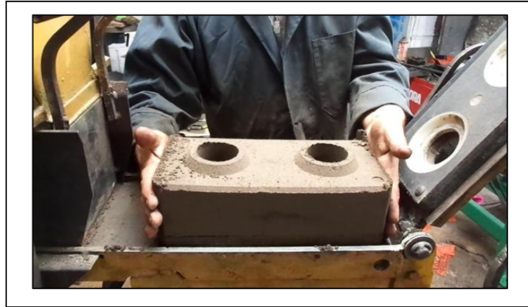
Gráfico N°13. Fabricación de ladrillos en la maquina prensadora.
