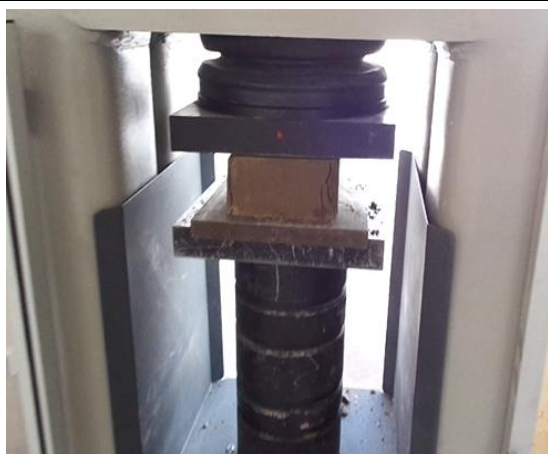
Ensayo de la Resistencia a la Compresión del Ladrillo
