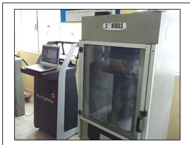
Gráfico N°16. Ensayo de Compresión en los Ladrillos Prensados Interconectables.
