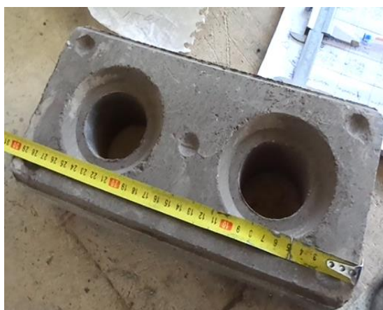
Medición de las Dimensiones del Ladrillo
