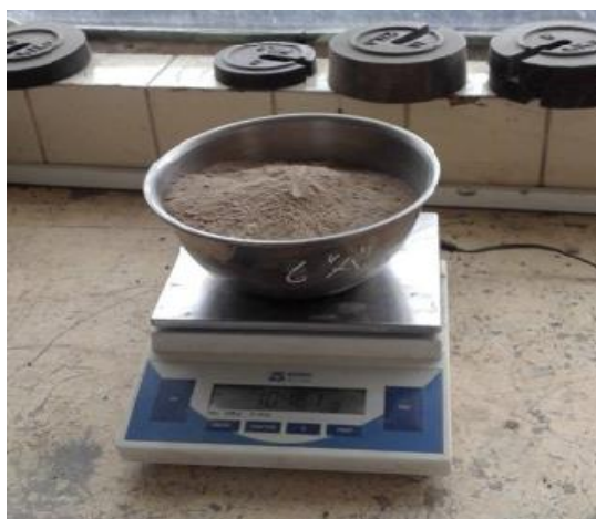
Pesaje de material para Ensayo Granulométrico.
