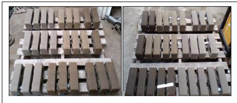
Gráfico N°14. Almacenamiento de ladrillos prensados interconectables.
