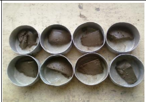
Muestra de Suelo para Contenido de Humedad de Límite Plástico
