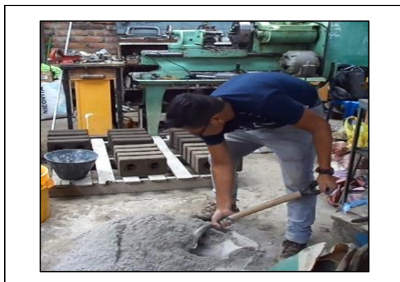
Gráfico N°11. Mezclado de material más porcentaje de cemento (sin agua).
