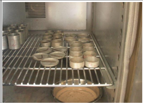
Secado de las Muestras en el Horno
