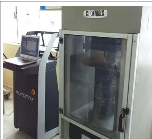
Ensayo de Resistencia a la Compresion
