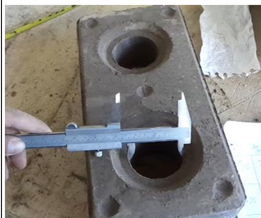
Medición de las Dimensiones del Ladrillo
