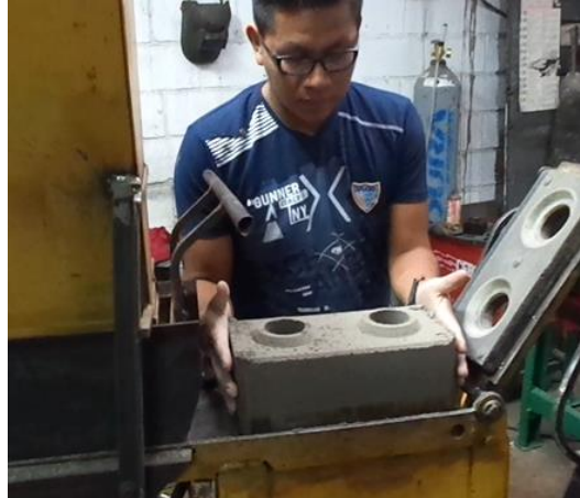
Fabricación de Ladrillos en la Maquina Presadora.
