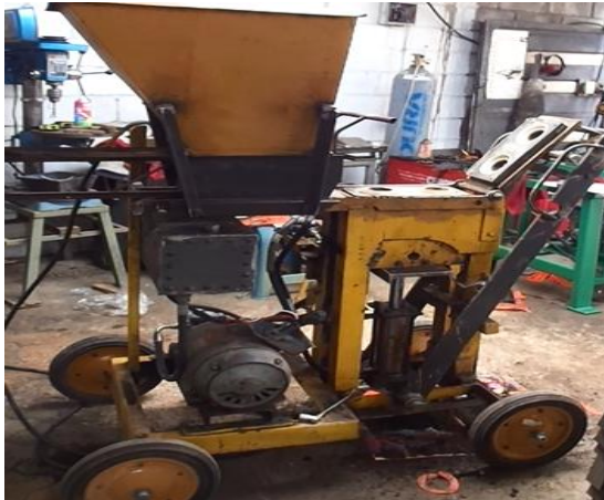
Maquina Presador de aproximadamente 7 Toneladas.
