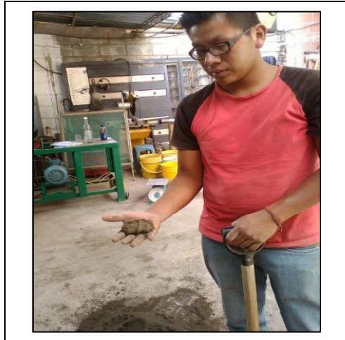
Gráfico N°12. Verificación de la humedad adecuada de la mezcla.
