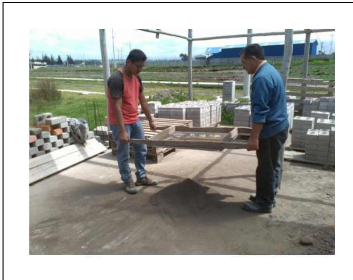
Gráfico N°10. Proceso de Tamizado de Materiales (tamiz # 4)
