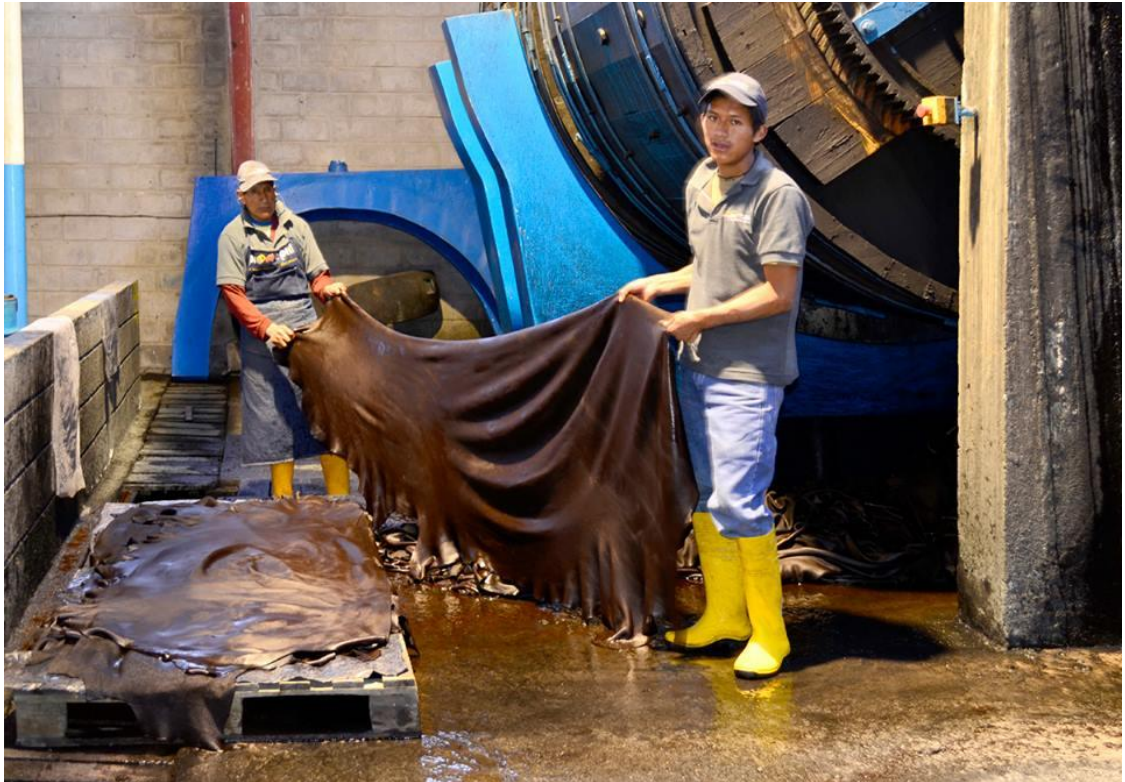
Ilustración 3 Proceso de teñido
