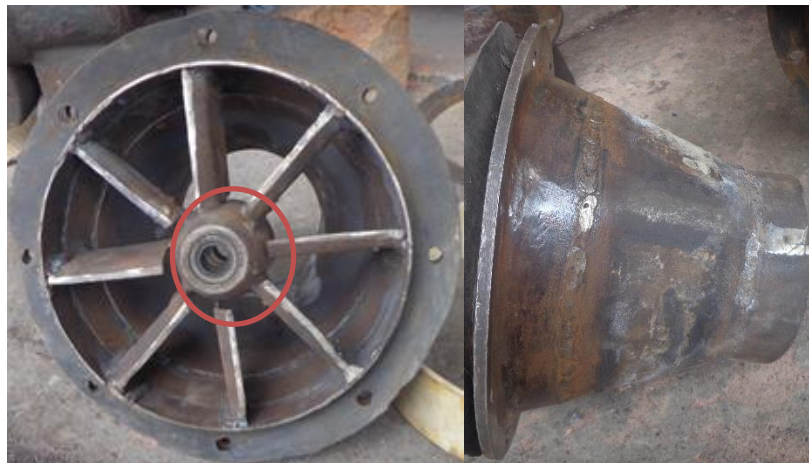
Figura B.11 Apoyo del eje cambiado a rodamientos
