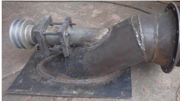
Figura B.26 Ducto de entrada con polea.
