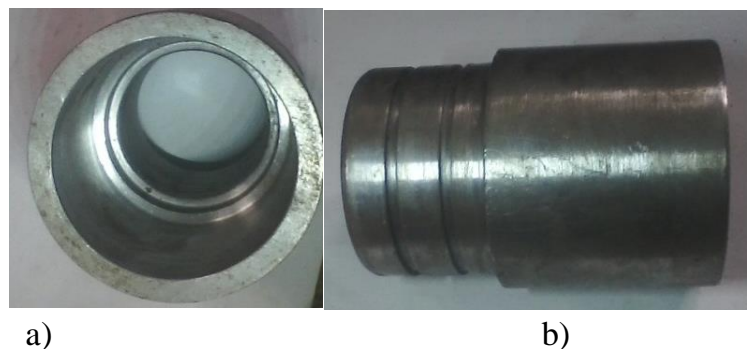
Figura B.17 Alojamiento para rodamientos vista a) frontal y b) lateral
