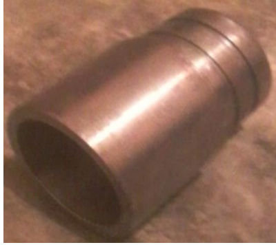
Figura 3.6 Alojamiento o apoyo maquinado para rodamientos.
