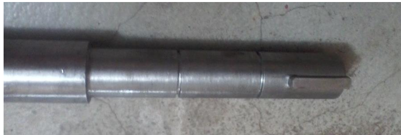
Figura B.14 Eje maquinado
