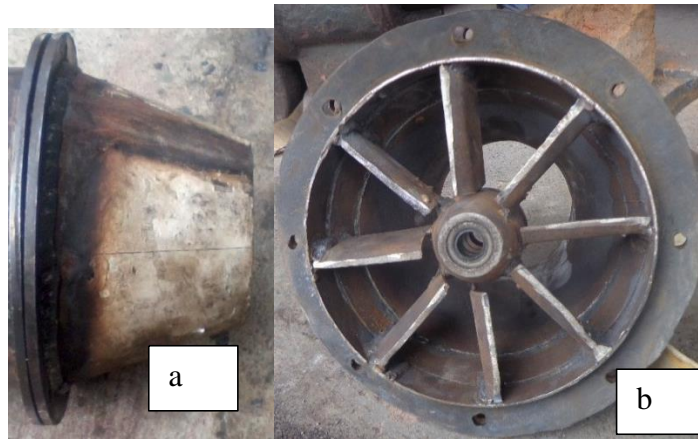
Figura B.10 a) tobera soldada a la brida y la guía; b) estator de la bomba
