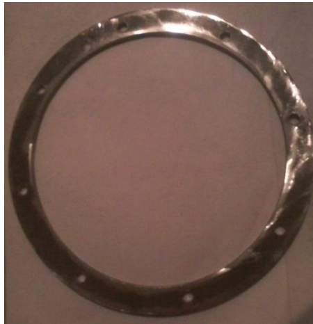
Figura B.8 Brida maquinada tipo Flat Face
