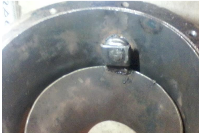
Figura B.19 Acople a la dirección
