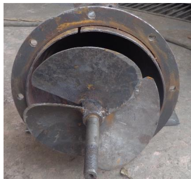
Figura B.25 Hélice con mayor ángulo de ataque
