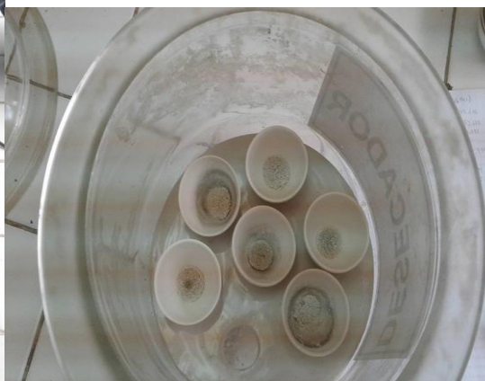
Peso después de incineración
