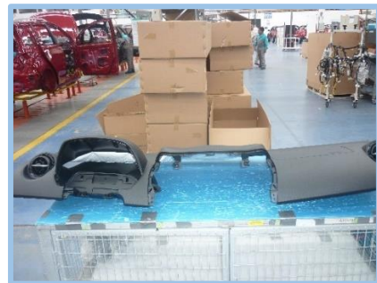
Figura 23. Preparación de la cubierta superior del panel de instrumentos.
