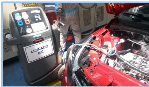
Figura 72. Llenado de Aire Acondicionado.
