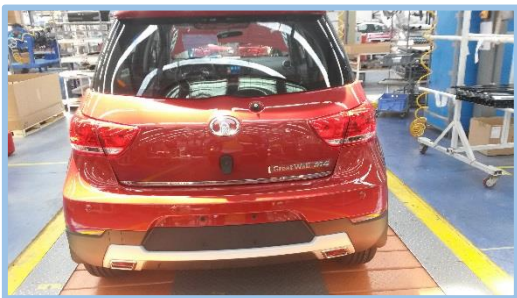
Figura 60. Colocación de logos de la compuerta.
