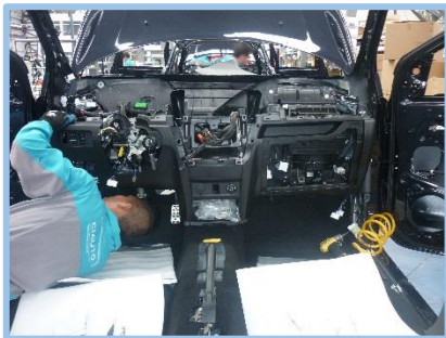
Figura 24. Montaje del Tablero.
