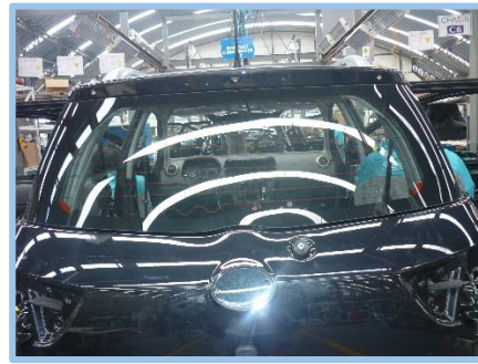
Figura 36. Parabrisas de compuerta instalado.
