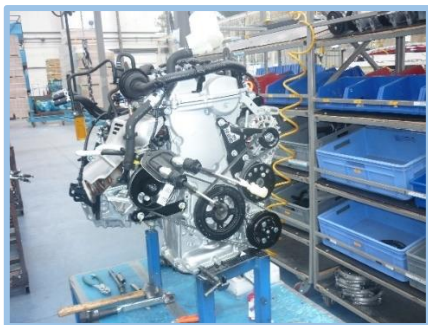
Figura 45. Instalación de bandas del compresor A/C.
