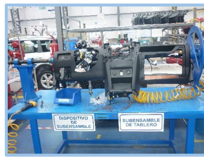
Figura 22. Sub-ensamble de Tablero terminado
