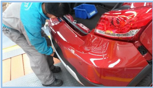
Figura 58. Colocación de guardachoque posterior
