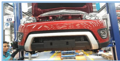
Figura 62. Guardachoque delantero instalado.
