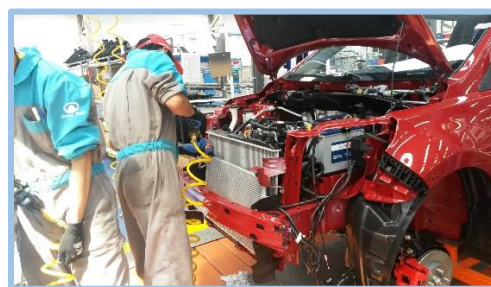
Figura 53. Instalación del radiador.
