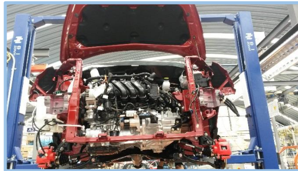
Figura 51. Tren Motriz instalado en su totalidad.
