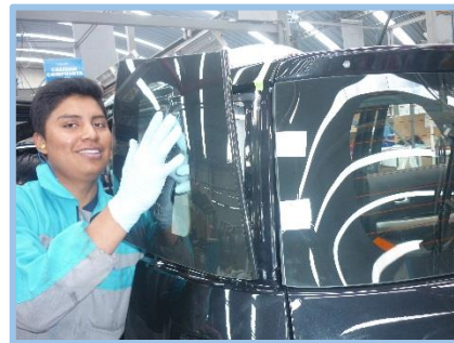
Figura 38. Instalación de la ventolera LH
