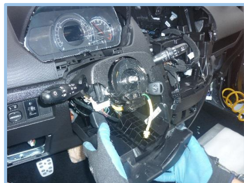
Figura 26. Colocación de las molduras de la columna de dirección.
