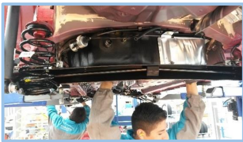
Figura 41. Montaje del tanque de combustible.
