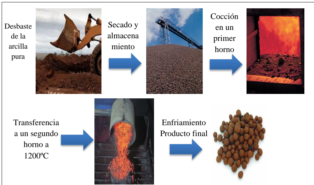
Gráfico 6. Proceso de fabricación industrial de la Arcilla Expandida
