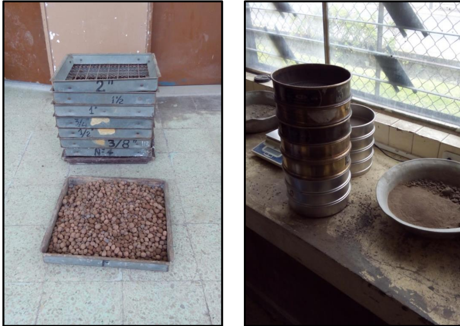
Fotografía 1. Tamizado de los agregados fino y grueso.
