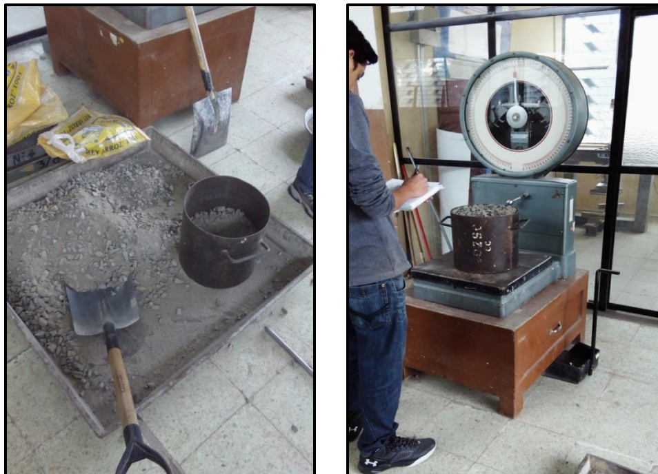
Fotografía 4. Ensayo densidad óptima de los agregados.
