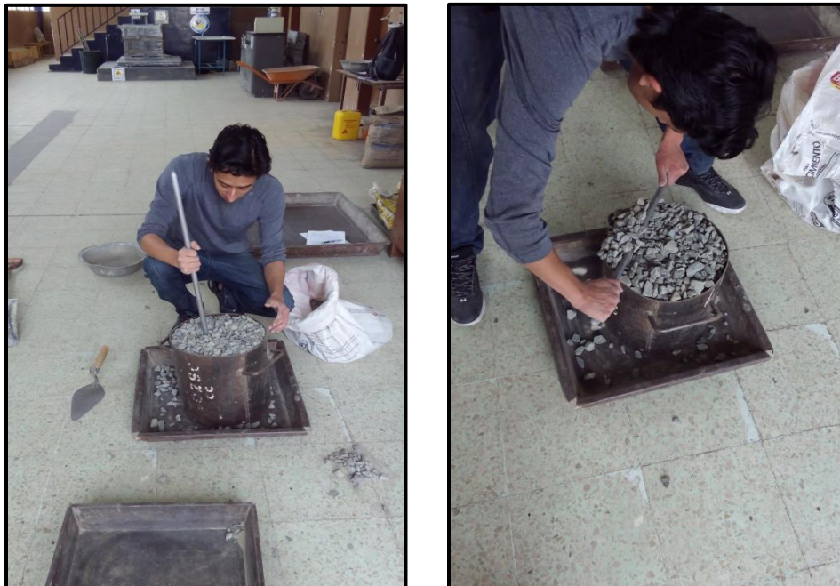
Fotografía 2. Ensayo densidad aparente compacta del agregado grueso.
