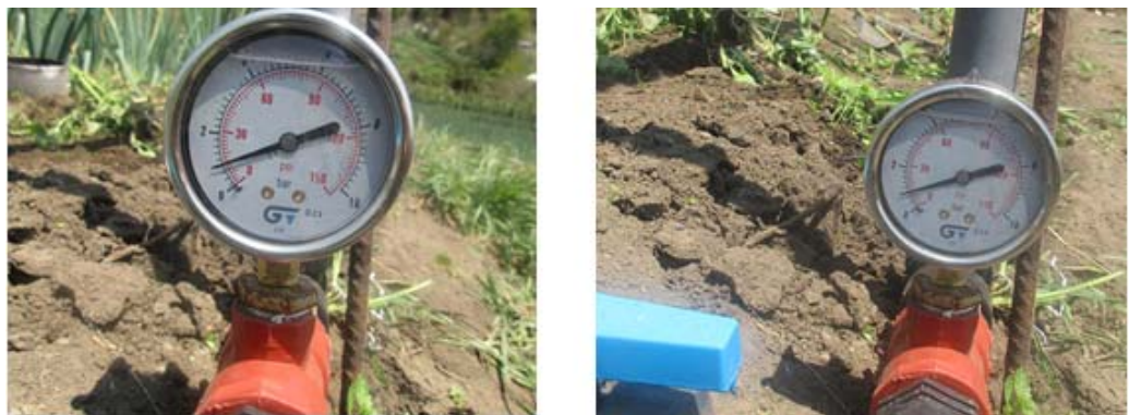
Figura 3. 11. Regulación de presión 1 bar constante durante 5 minutos (Fuente: Autor)
