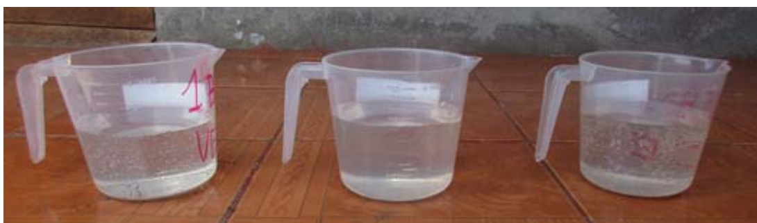
Figura 3. 16. Estabilidad del caudal de un emisor autocompensado (Fuente: Autor)
