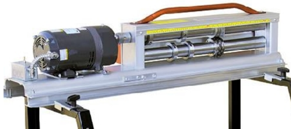
Figura 3.7: Esquema de transmisión de potencia por motorreductor [21]
