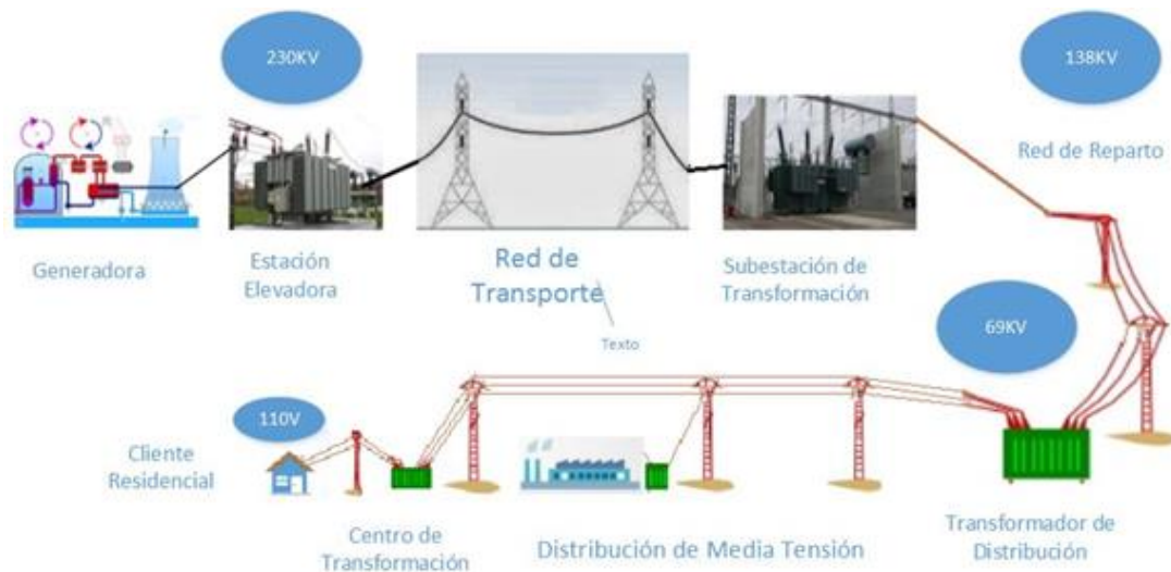
Figura 4.1 Estructura del Sistema Eléctrico
