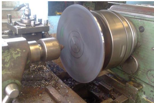
Fig. 3.12: Placa de acero siendo mecanizada en el torno [El Autor].
