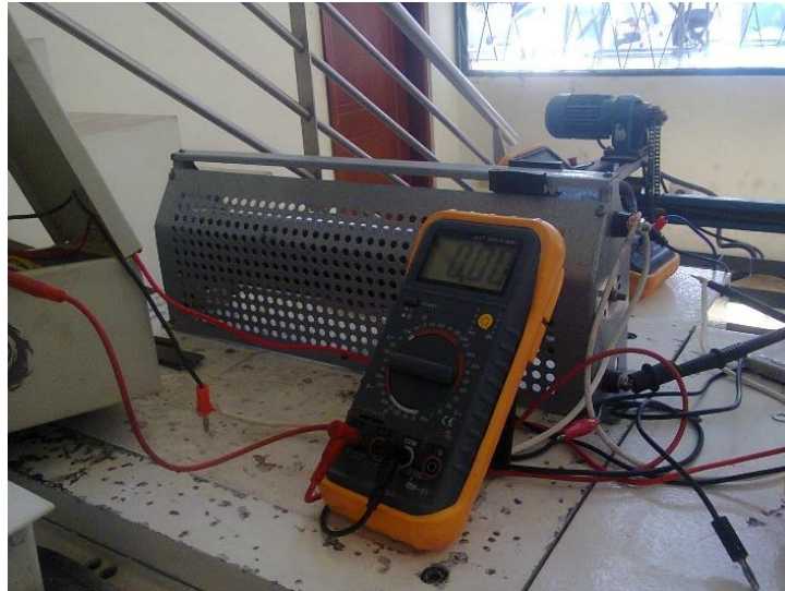
Fig. 4.3: Conexión del reóstato y multímetros. [El Autor]
