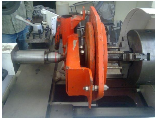
Fig. 4.1: Montaje del generador en el torno. [El Autor]
