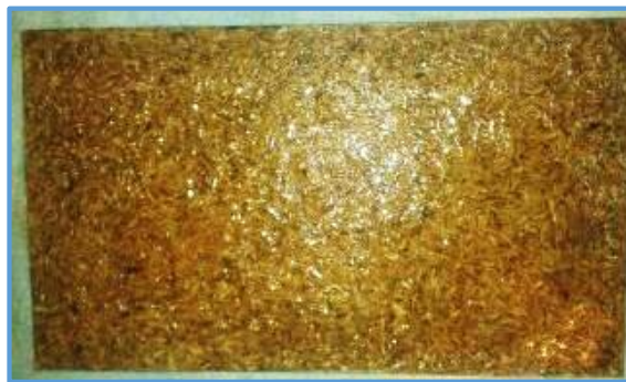
Figura 4.9. Curado del material compuesto (RP+CA) con un lapso de tiempo de 10 días. (Fuente: Realizado por el Autor)
