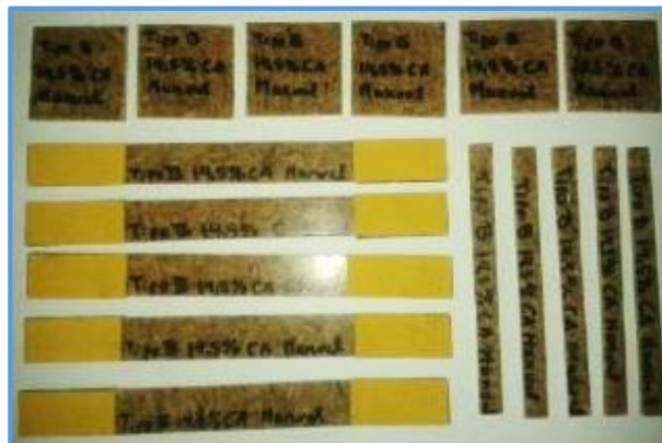
Figura 4.10. Corte de probetas para ensayo a tracción (Norma ASTM D3039-14). (Fuente: Realizado por el Autor)
