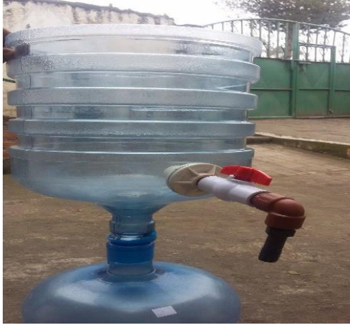
Colocación de válvula de descarga del agua residual tratada
