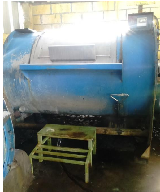
Maquina par ale tinturado, Stock Washed, desengomado y teñido.
