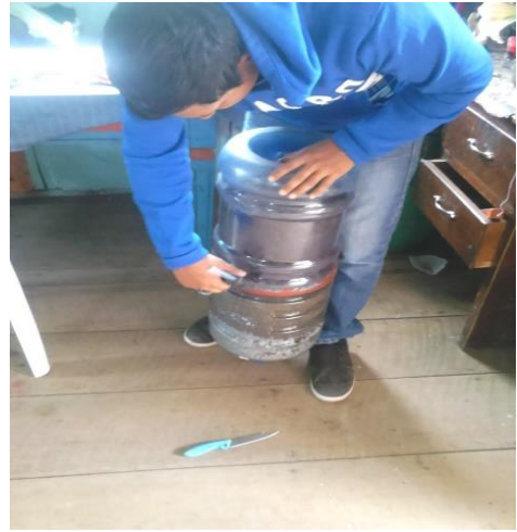
Sellado con silicona de las uniones de la columna de biofiltración.
