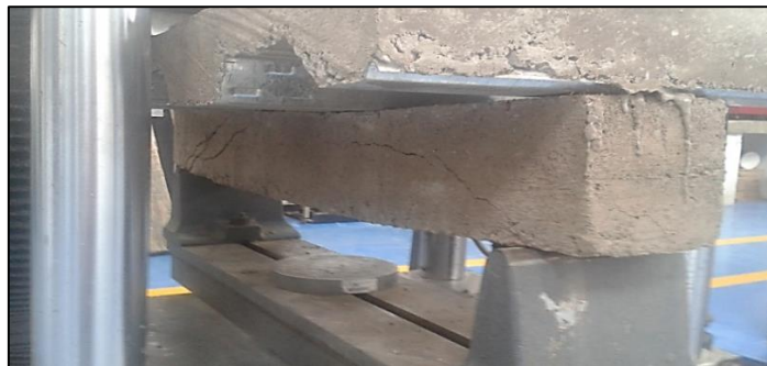
Gráfico N° 50. Fisuras en la Viga de H°A°
