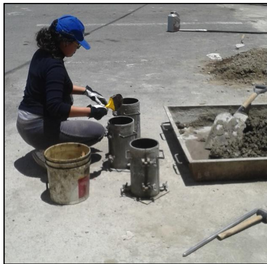
Gráfico N° 16. Llenado de los Moldes de Cilindros
