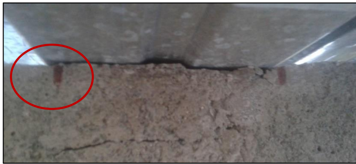
Gráfico N° 55. Desplazamiento Losa Compuesta – Viga de H°A°
