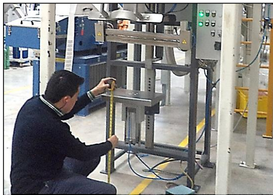
Figura 123: Definición de la altura de la repisa
