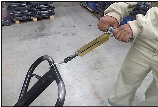
Figura 97: Uso de la balanza para mediciones de fuerza
