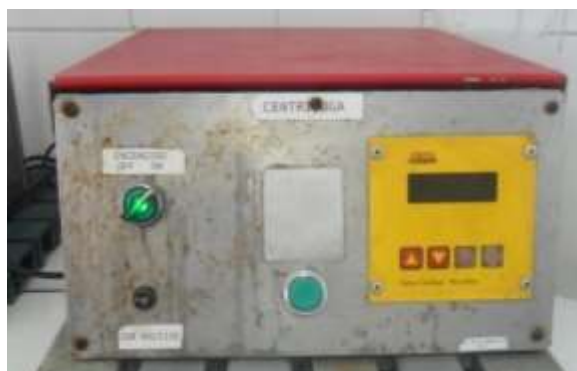
Figura 3. Centrífuga Gerber utilizada para la determinación de grasa
