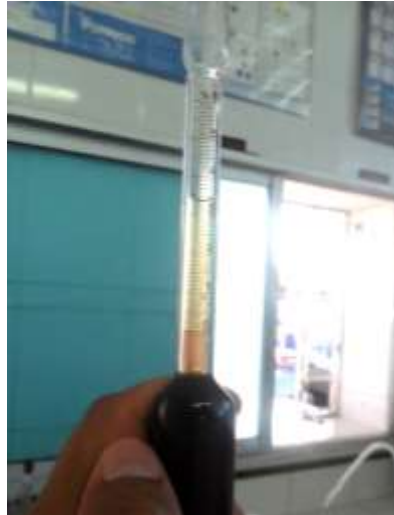
Figura 4. Lectura de la cantidad de grasa que contiene la muestra de leche analizada
