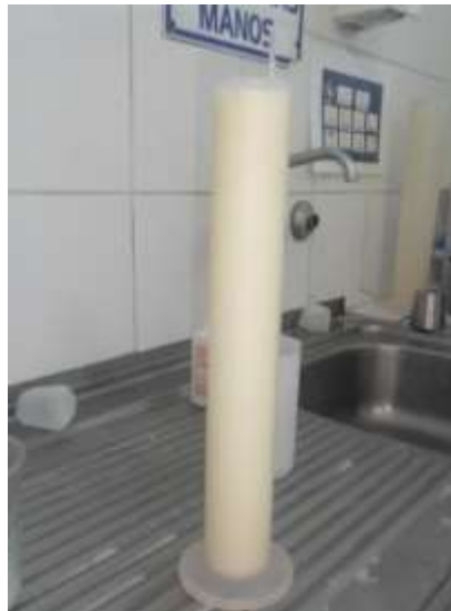
Figura 5. Medición de densidad y temperatura a través del termolactodensímetro Quevenne calibrado a 15° C.
