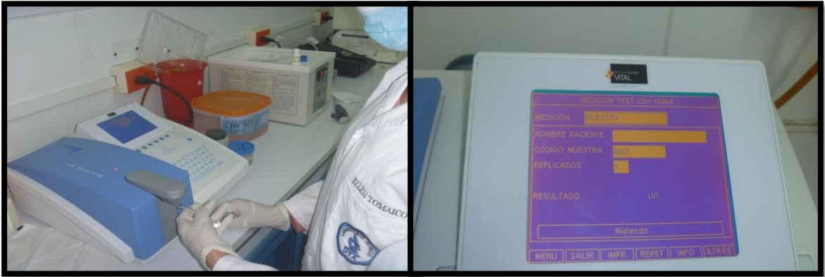
Fotografía 8.- Se procedió a realizar la lectura de niveles de la enzima Lactato Deshidrogenasa en el Espectrofotómetro
