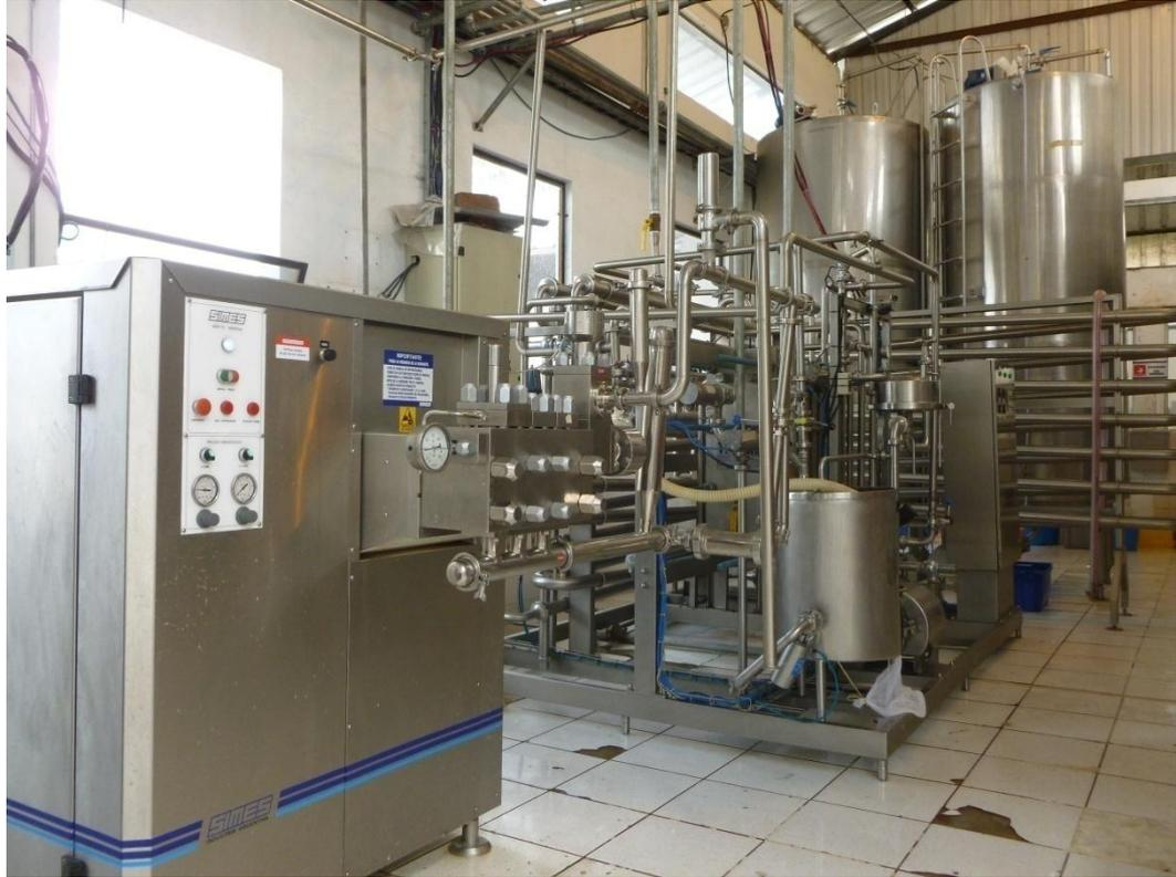
En la moderna planta pasteurizadora, primará la higiene para garantizar la calidad del producto, el recipiente de pasteurización tiene un medidor de temperatura digital externo que evita la mano del hombre.
