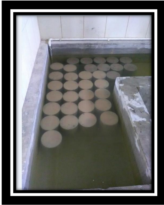
Curado del hormigón
