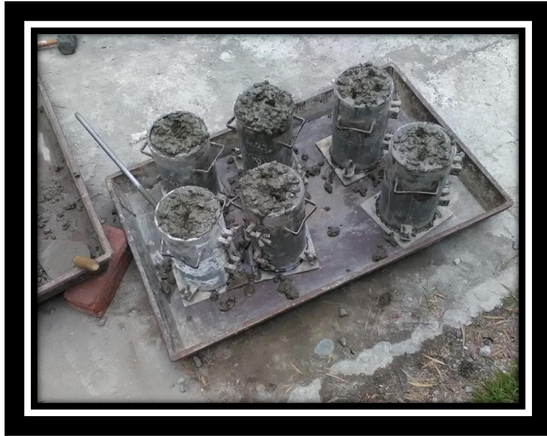
Cilindros de hormigón
