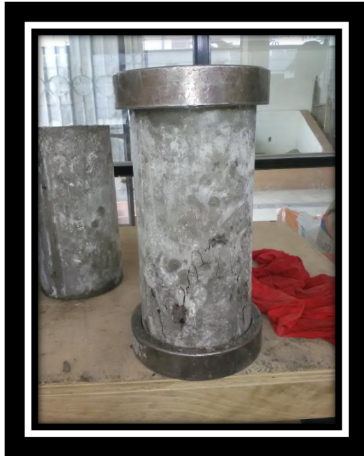
Fallas en los cilindros de hormigón después de ensayar
