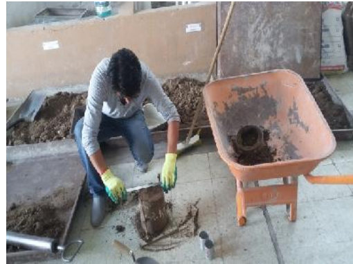
Enrasado de muestra (Densidad Óptima)
