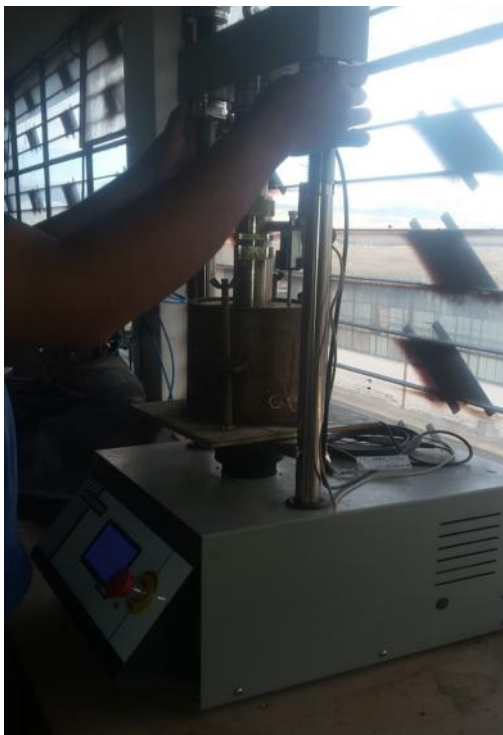
Ensayo de CBR
