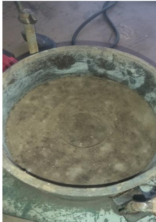
Huella dejada por el pistón ensayo CBR
