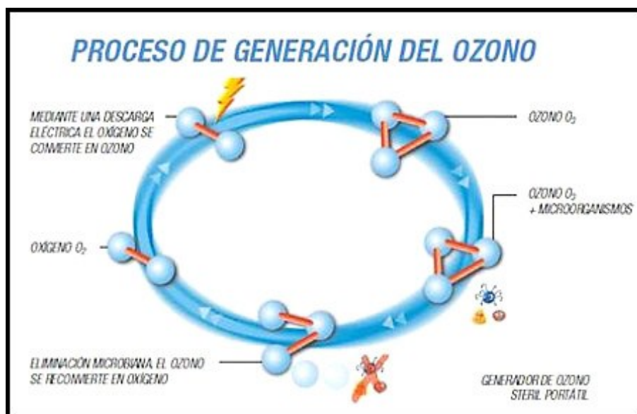
Figura 1: Proceso de generación de ozono por radiación ultravioleta - descargas eléctricas. Fuente: Beutelspacher & Calderón, 2014.
