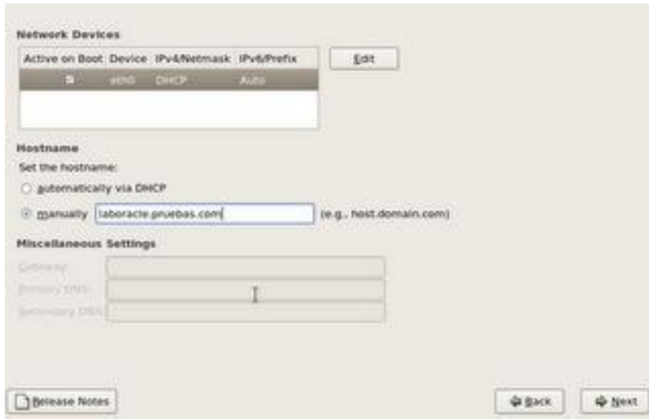
Figura 6.6 Configuración del direccionamiento IP del servidor
