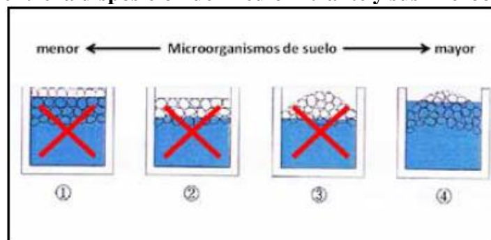
GRÁFICO N° 14 Relacion entre la disposicion del medio filtrante y sus microorganismos.
