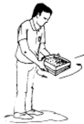
Figura 2. 4: Movimiento del cedazo manual.
