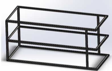
Figura 6. 27: Estructura para planchas perforadas
